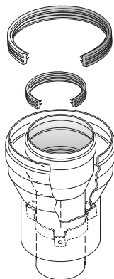
Redukce z ø 60/100 na ø 80/125
