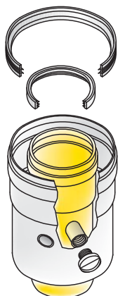
Vsuvka ø 60/100 do kotle s odběry
