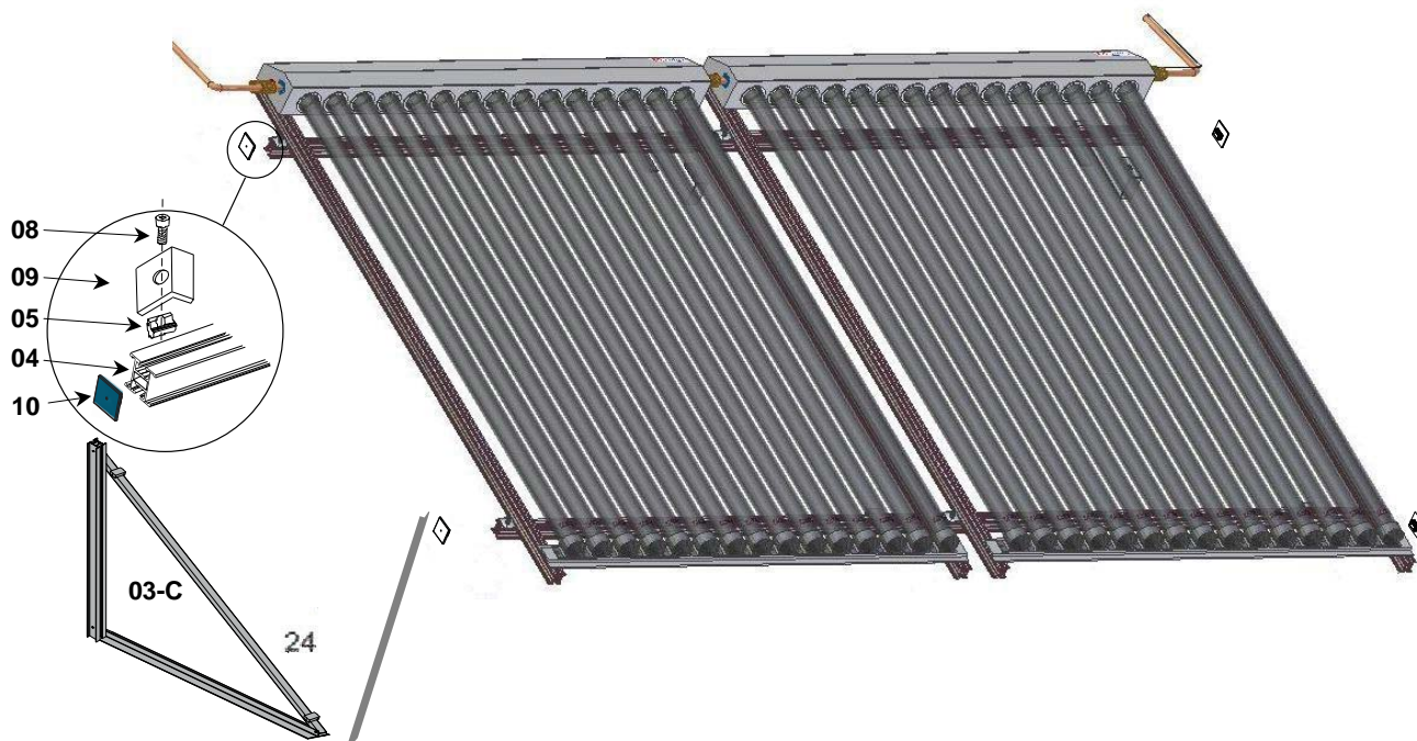
Obr. 15: Trojúhelníková podpěra a zavětrovací vzpěra
