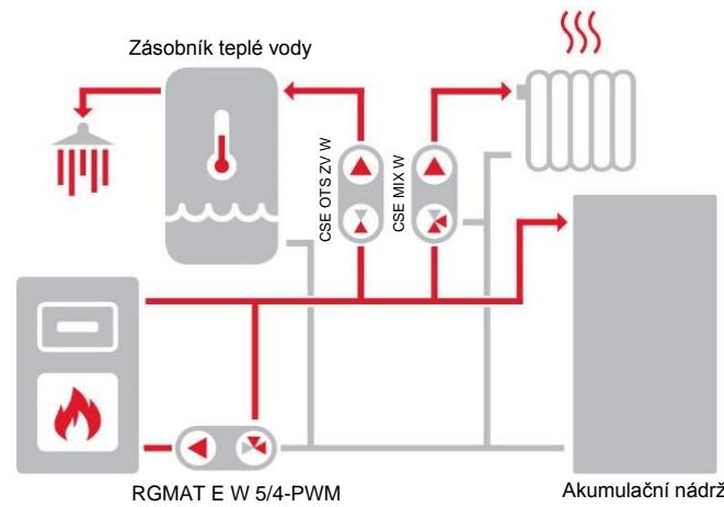
Schéma zobrazuje typické zapojení kotle na tuhá paliva, akumulační nádrže a otopného okruhu (s doporučenou čerpadlovou skupinou CSE MIX W - není součástí dodávky). Pokud je kotel využíván také pro přípravu TV, doporučujeme instalovat čerpadlovou skupinu CSE OTS ZV W (není součástí dodávky).
