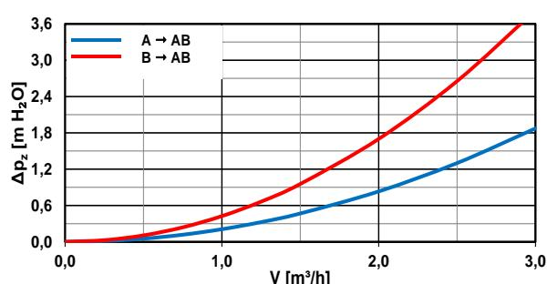
V průběhu směšování se tlaková ztráta ventilu pohybuje mezi křivkami v závislosti na směšovacím poměru
