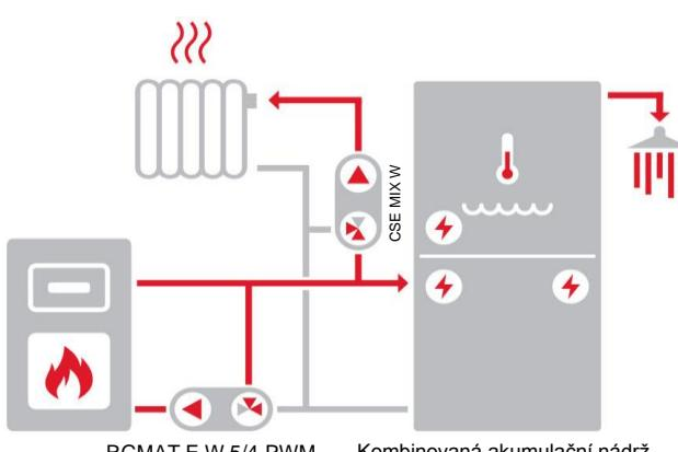
Schéma zobrazuje typické zapojení kotle na tuhá paliva, kombinované akumulační nádrže (s možností přípravy teplé vody) a otopného okruhu (s doporučenou čerpadlovou skupinou CSE MIX W - není součástí dodávky).
